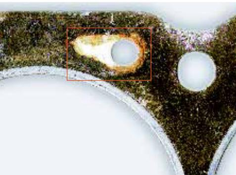
▲ *Rigonfiamenti sulle guarnizioni della testata in materiale morbido a causa del surriscaldamento con formazione di vapore.*
