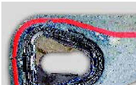
▲ *Strappo o rottura del materiale morbido e elemento Viton danneggiato per l'applicazione inadeguata di sigillanti aggiuntivi.*
